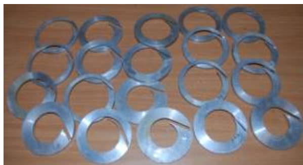
Рис. 3. Подводящие устройства кольцевого и спирального типа
