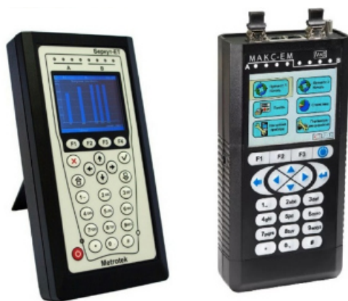
Рис. 1. Внешний вид тестеров-анализаторов (слева – Беркут-ЕТ, справа – МАКС-ЕМ)
