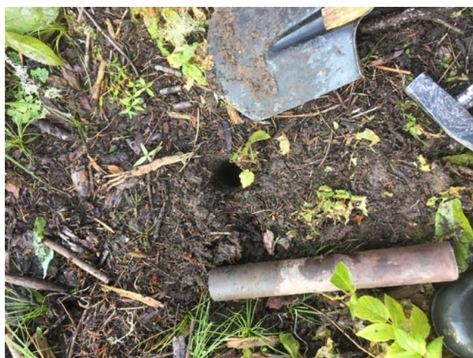
Рис. 2. Взятие образца почвы буром Качинского
