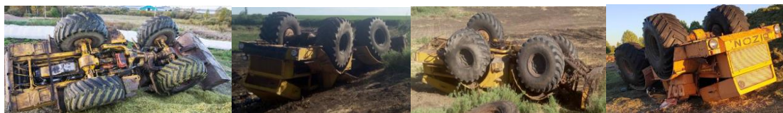
Рисунок 1 - Опрокидывание трактора с шарнирно-сочлененной рамой
