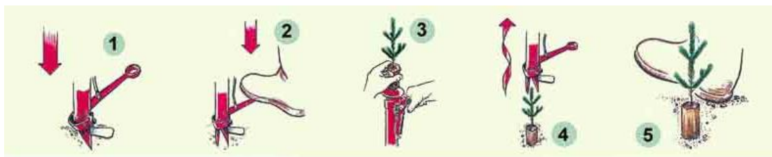
Рисунок 1 - Орудие для посадки ручным способом «Поттипутки»
