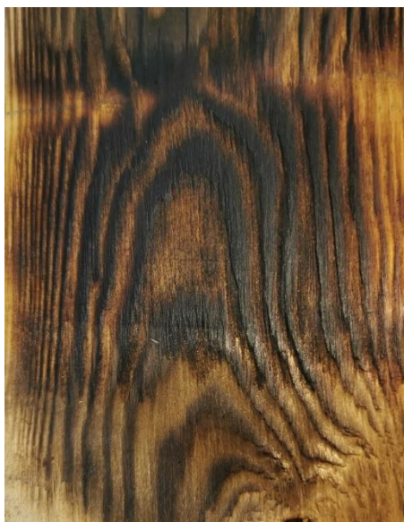
Рисунок 1 – Древесина после обжига и браширования
