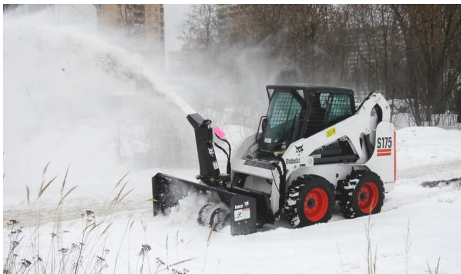
Рисунок 1– Фотография снегоуборщика на базе погрузчика S175 (Bobcat) до модернизации
