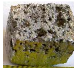
Рис. 3. Образец из пеноалюминия марки А7. Размер 40×35×35 мм
