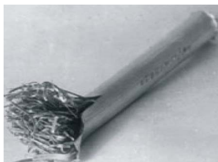
Композит, отпрессованный из гранул сплава АД и нанопорошка карбонитрида титана TiCN
