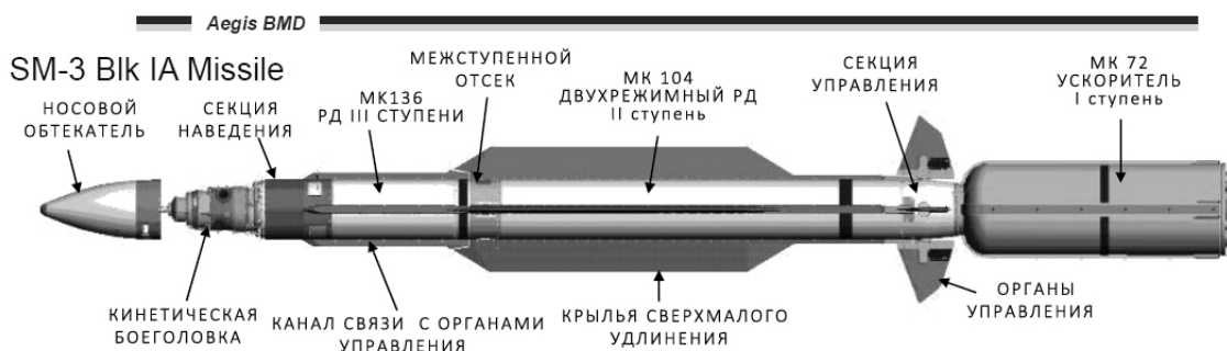
Рис. 1. Компоновочная схема SM-3 (RIM-161)
