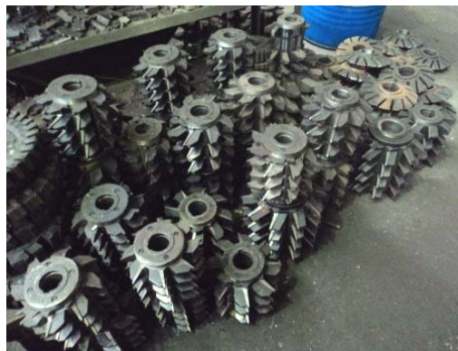
Рис. 2. Изношенные червячные фрезы
