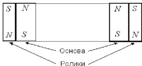
Рис. 1. Схема удержания роликов намагниченной основой
