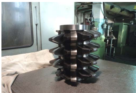
Рис. 1. Сборная червячная фреза модулем 20 мм
