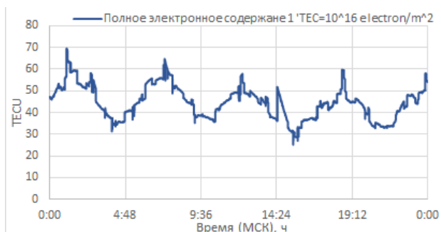
Рис. 2. Суточный ход полного электронного содержания ТЕС в ионосфере, результаты с навигационного приемника МРК-33 17 ноября 2012 г.
