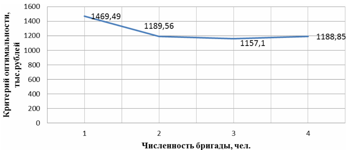
Рис. 2. Зависимость затрат на содержание ремонтного персонала и потерь, связанных с простоем оборудования, от численности ремонтных бригад
