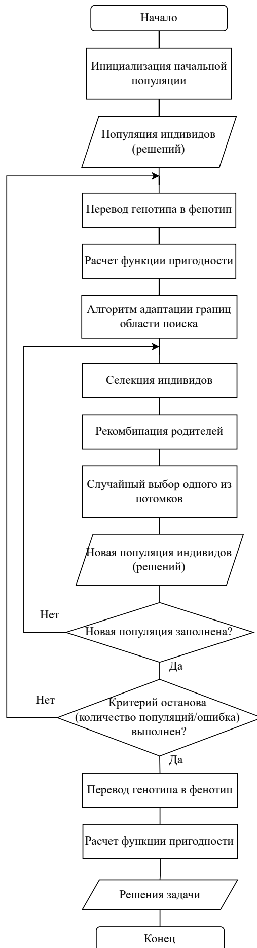
Рисунок 2.1 — Общий процесс работы генетического алгоритма с динамической коррекцией области поиска.
