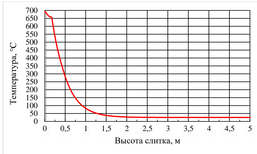
Рисунок 2.15 - График расчета температуры слитка по высоте.
