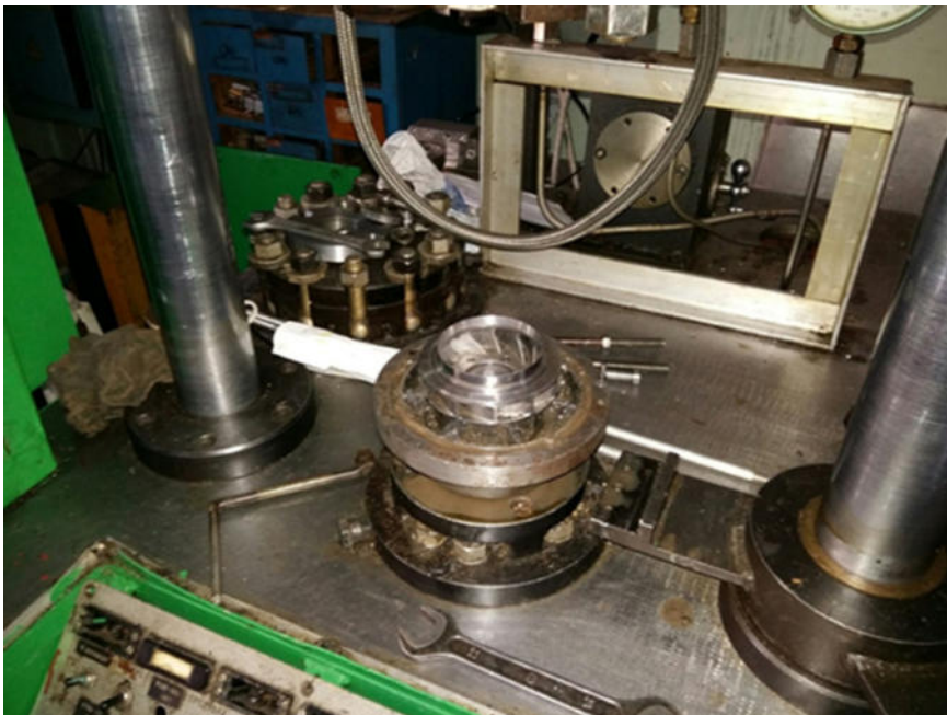
Рисунок 11 - Обработка абразивным потоком крыльчатки на опытно-промышленной установке УЭШ-100
